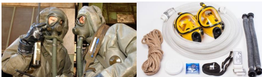
Рис.14.Шланговые противогазы типа ПШ-2
