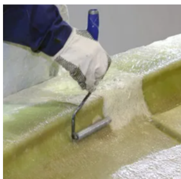
Рис.10. Приформовка препрега кистью
